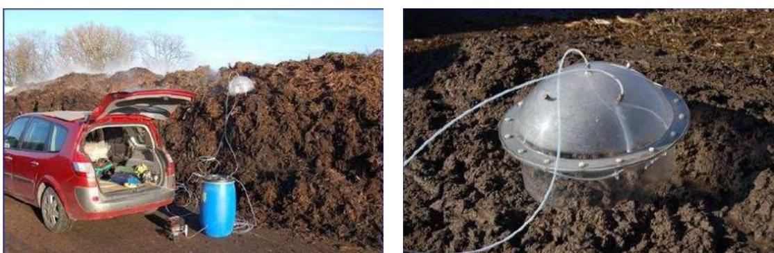
**Figure 14 : Réalisation des échantillons d'odeur**
