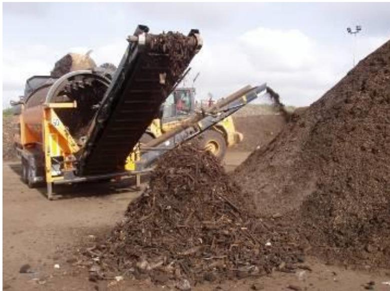
**Figure 11 : Opération de criblage**
