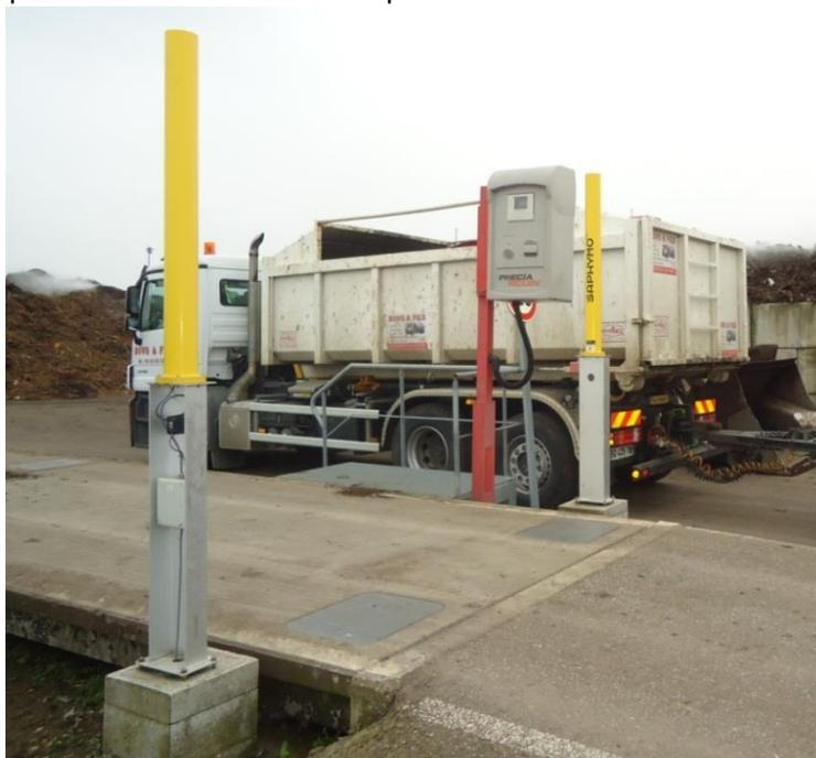
Figure 7 : Pont-bascule avec détecteur de radioactivité
